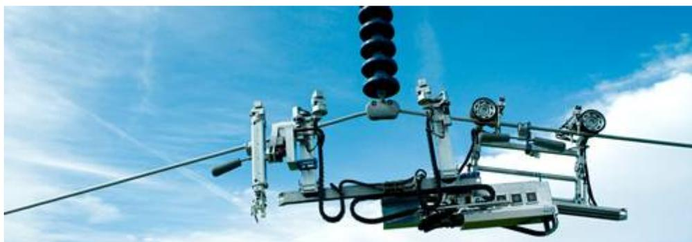
Figure 3 : exemple de robot de maintenance de ligne électrique
